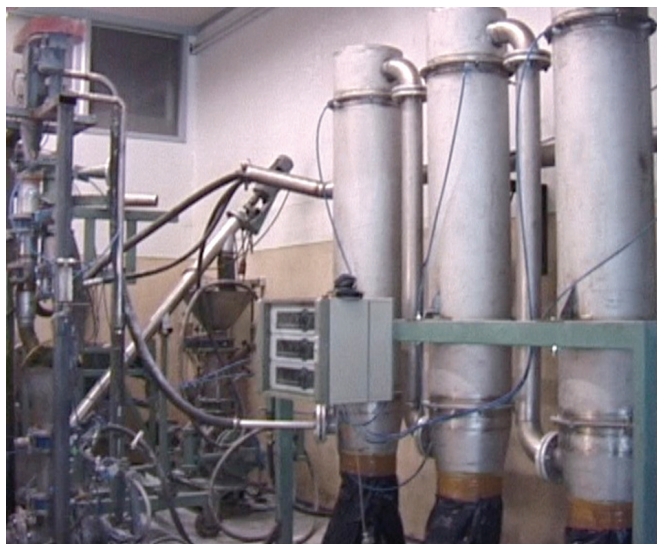
Vastasuihkujauhin ja Ionihiukkasluokitin koelaitoksella erottelevat mineraaleja ( 1 mg platinaa / 1000 kg malmia )
