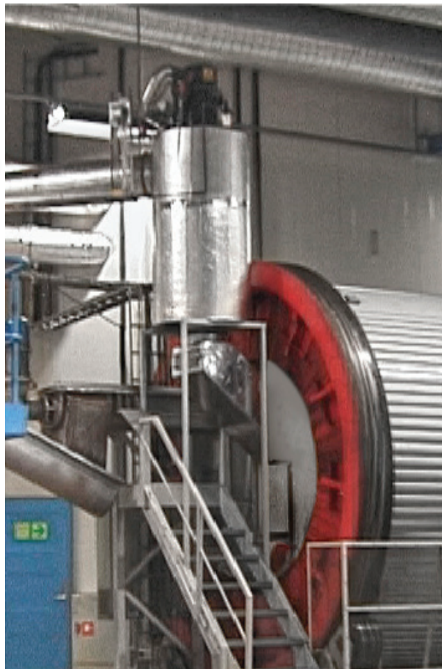
Jokaisessa biohapettimessa on ilmanpuhdistuslaitteet. (30 000 m³/h)
