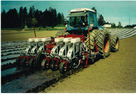
Automaattinen kylvökone tekee kasvatuspenkin, kiinnittää Biofilmi-katekalvon sen päälle ja kylvää siemenet kalvoon tekemiensä reikien läpi.
